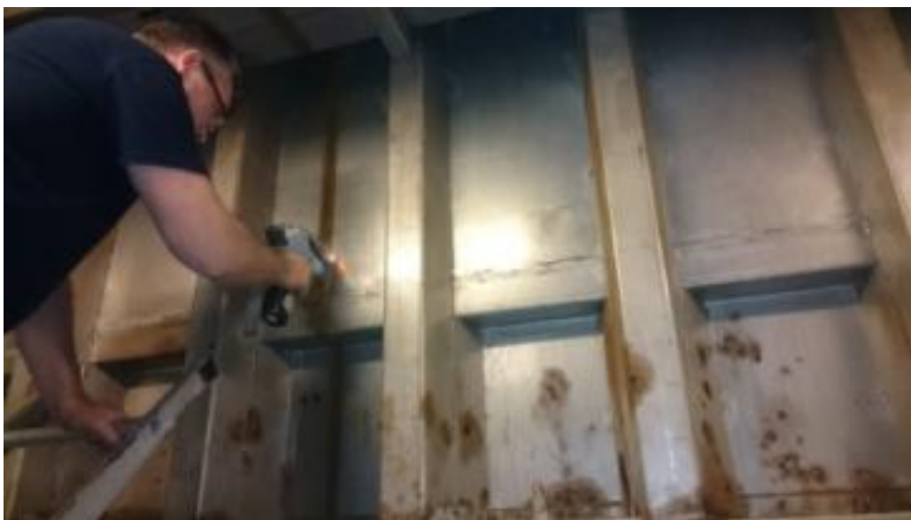
Figur 1. PMI undersøkelse av material (kjemisk analyse basert på spektroskopi).
